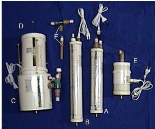
Figura 1. Peças principais do aparelho isoladas: A) Válvula de PEEP, B) Válvula de Segurança, C) Cilindro Principal, D) Fole, E) Umidificador e F) Distribuidor de Ar.
